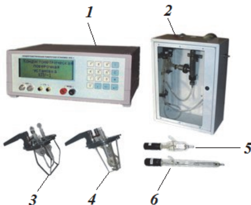
Рисунок 1 – кондуктометрическая поверочная установка КПУ-1: 1 - встроенный четырехстрочный дисплей; 2 – короб с компрессором; 3-6 – кондуктометрические ячейки типов А, Б, В, Д (таблица 1)
