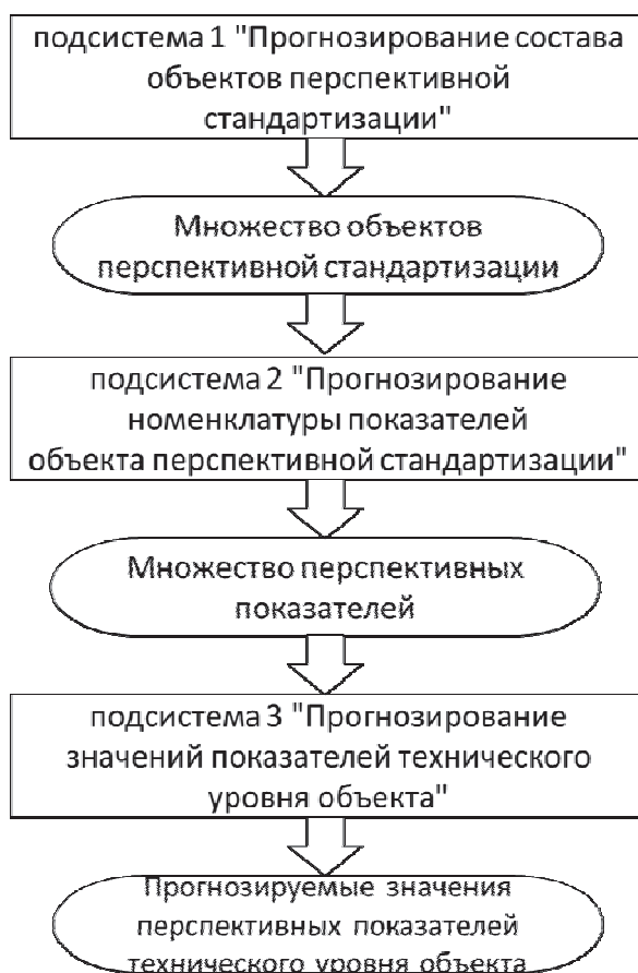
Рисунок 1 – Блок-схема системы прогнозирования показателей технического уровня продукции машиностроения [4]
