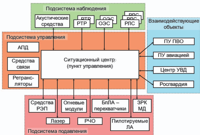
Рисунок 3 – Структурная схема системы противодействия БпЛА
