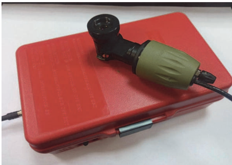
Рисунок 2 – Специальная коллимационная окулярная насадка
