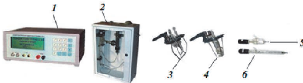
Рисунок 1 – Кондуктометрическая поверочная установка КПУ-1: 1 – измерительно-вычислительный блок; 2 – короб с компрессором; 3-6 – первичные преобразователи
