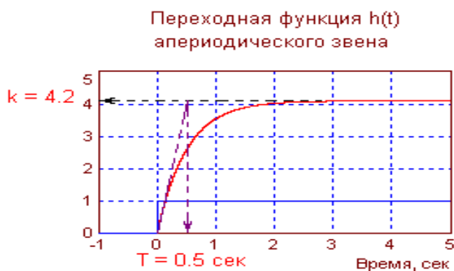
Рисунок 2.3 - Переходная функция аперiodического звена
