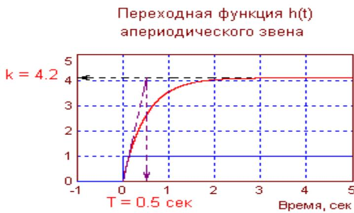
Рис. 2.3. Переходная функция аperiодического звена
