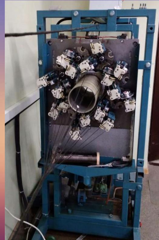
Плетельно-пултрузионная установка на базе ШП-16
