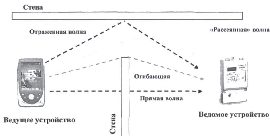
Рисунок 1 – Модель многолучевого распространения радиоволн [4]
