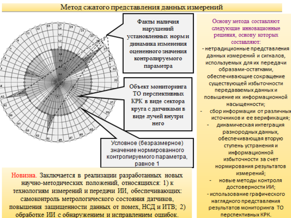
Рисунок 2 – Иллюстрация основных научно-методических положений предлагаемого метода сжатия данных ИИ и его предполагаемого развития при разработке АСМ ТО перспективных КРК
