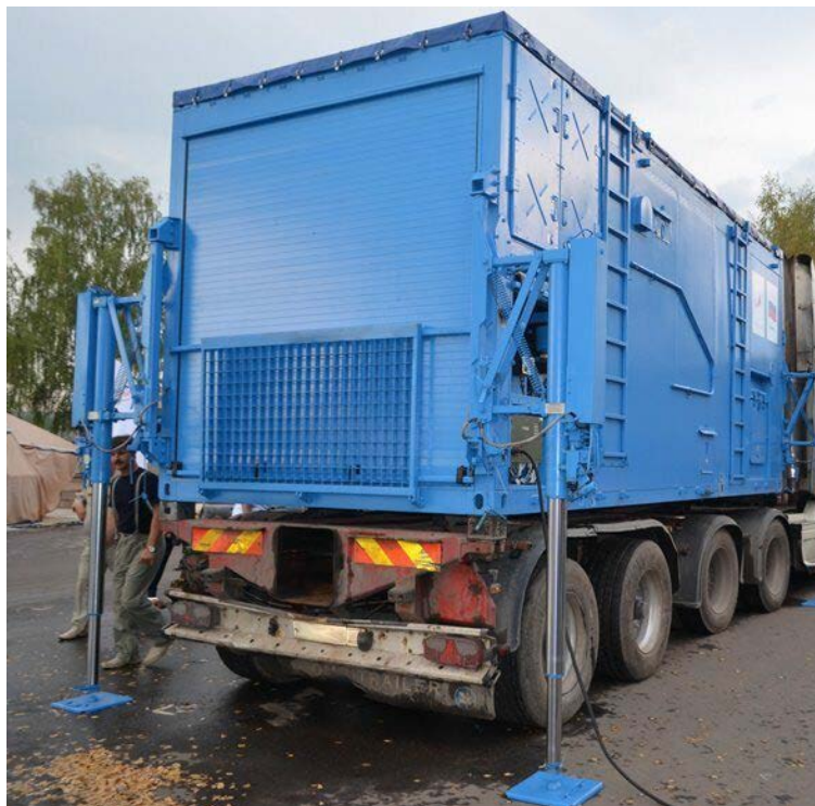
Рисунок 5 – Мобильный измерительный пункт с гиросtabilизированной платформой
