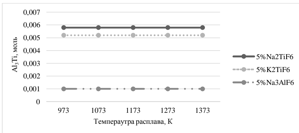
Рисунок 4 – Изменение количества побочной фазы \text{Al}_3\text{Ti} в зависимости от вида соли
