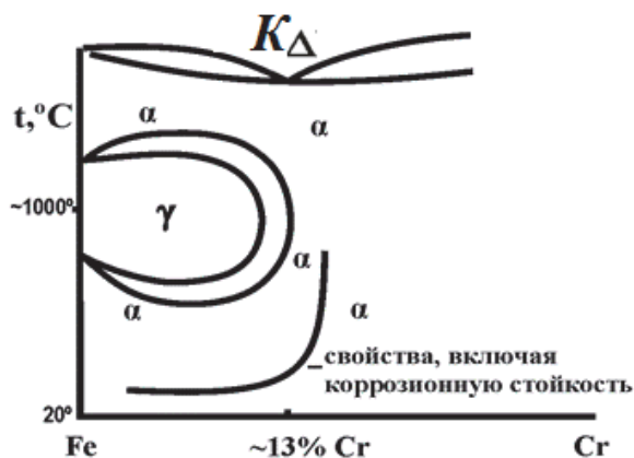
Рисунок 4 – Диаграмма фазового равновесия системы Fe – Cr [10]
