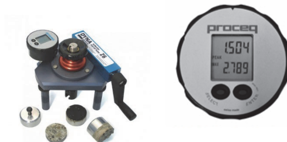
Рисунок 5 – Прибор – DYNA «PROCEQ» (Швейцария, г. Шверценбах), реализующий механический метод неразрушающего контроля прочности бетона – метод отрыва. Общий вид прибора (слева), показания электронного блока (справа)
