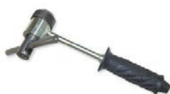
Рисунок 3 – Прибор – Молоток Кашкарова (Россия), реализующий механический метод неразрушающего контроля прочности бетона – метод пластической деформации. Общий вид прибора (слева), тарировочные кривые для молотка Кашкарова (справа)
