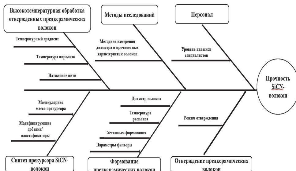
Рисунок 1 – Диаграмма Исикавы для определения технологических параметров, влияющих на качество прочность SiCN-волокон
