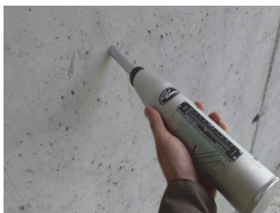
Рисунок 1 – Прибор – Склерометр (молоток Шмидта) «PROCEQ» (Швейцария, г. Шверценбах), реализующий механический метод неразрушающего контроля прочности бетона – метод упругого отскока.
