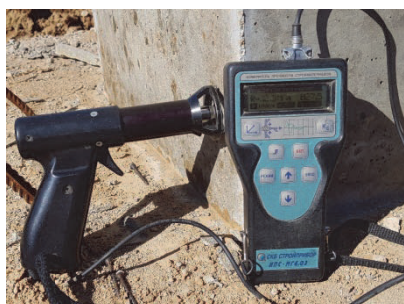
Рисунок 4 – Прибор – ИПС-МГ4.03 СКБ «Стройприбор» (Россия, г. Челябинск), реализующий механический метод неразрушающего контроля прочности бетона – Метод ударного импульса. Общий вид прибора (слева), показания электронного блока (справа)
