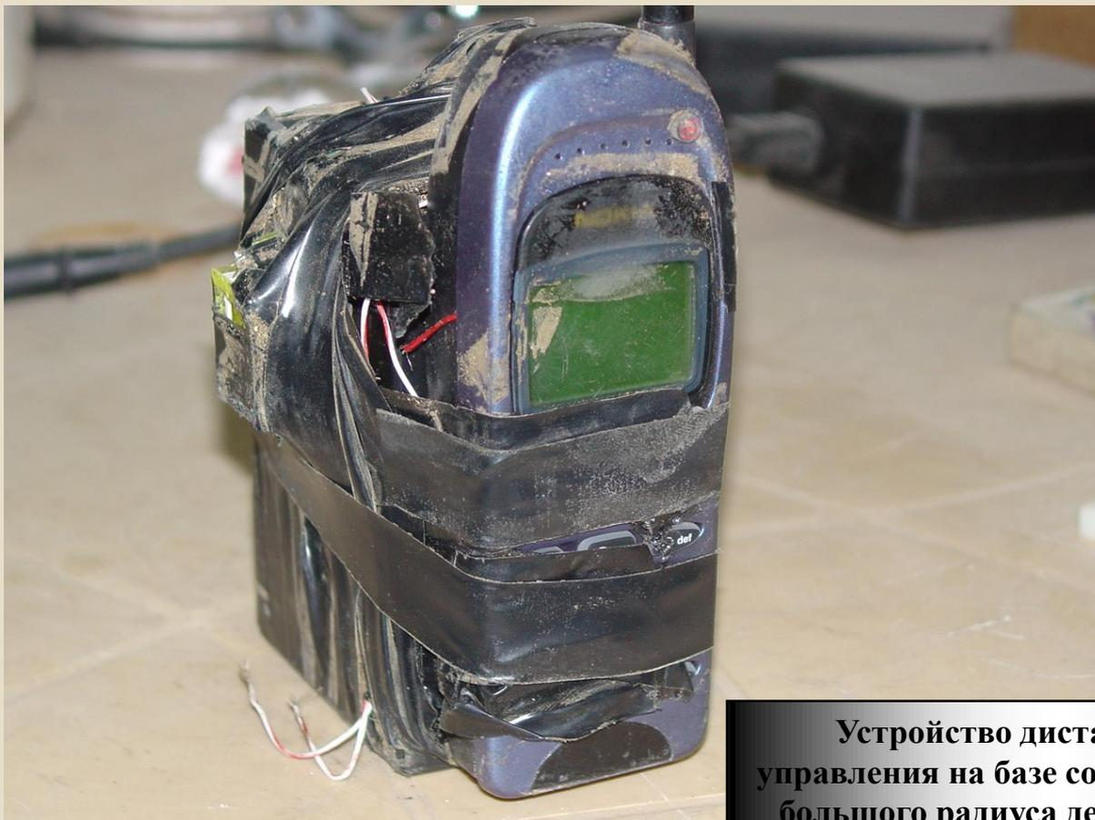
Устройство дистанционного управления на базе сотового телефона большого радиуса действия фирмы «Нokia»
