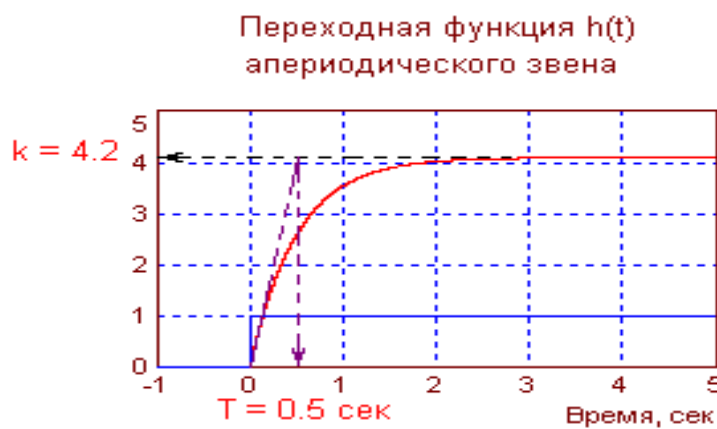
Рис. 2.3. Переходная функция аperiodического звена
