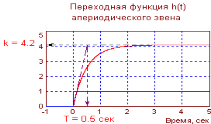
Рис. 2.3. Переходная функция апериодического звена
