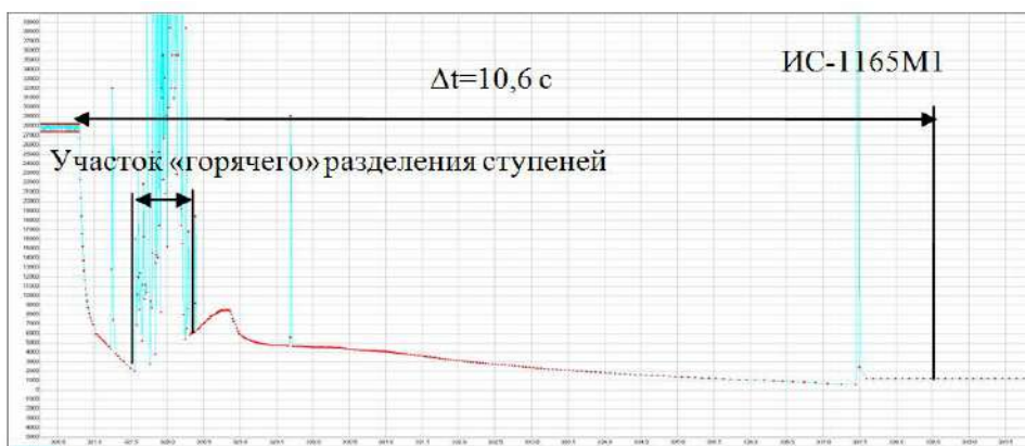
Рисунок 9 – Изменение параметра OT21 при останове ТНА двигателя второй ступени по данным преобразователя ИС-1165М1
