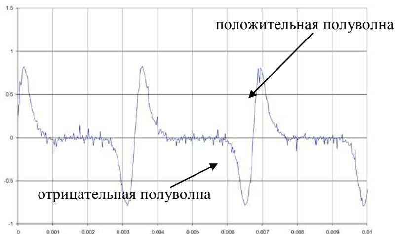
Рисунок 2 – Форма выходного сигнала датчика числа оборотов ИС-386
