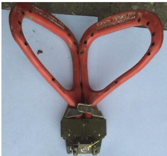
**Рисунок 8 – Поручни РК КУ типа К-36Д-3,5 с основанием, находящимся в отклонённом положении (стрелкой указано место разрушения штока шарнирного соединения)**
