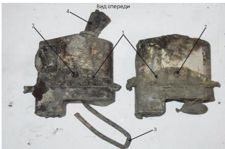
1 – корпус гнезда; 2 – замок РК; 3 – хомут; 4 – фрагмент поручня РК
