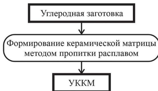
**Рисунок 1 – Схема технологического процесса получения углерод-керамического композиционного материала методом пропитки расплавом**
