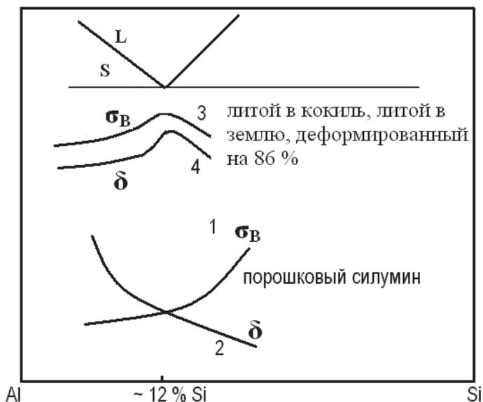
Рисунок 3 – Схематизированная диаграмма состояния и зависимость свойств от содержания кремния (данные Г.Б. Строганова и др.)
