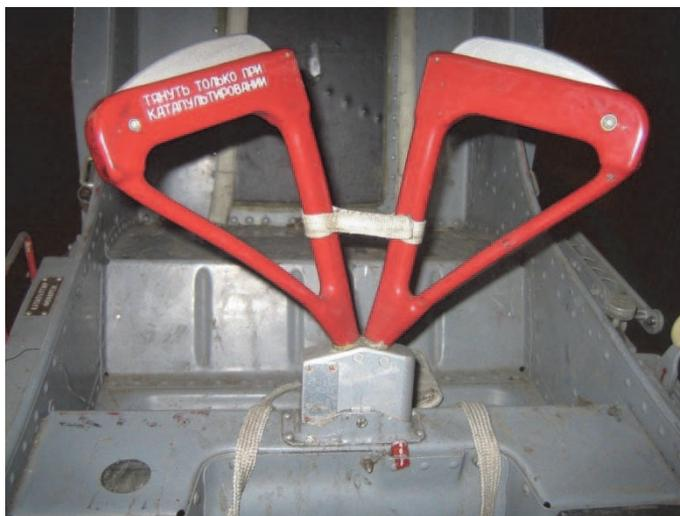
**Рисунок 7 – Расположение РК на чашке катапультного кресла типа ВС-1БРИ**
