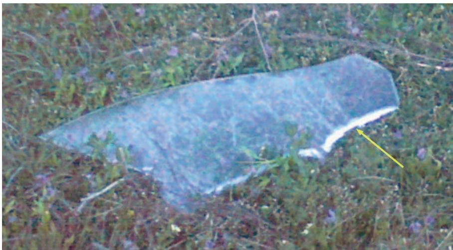
**Рисунок 1 – Фрагмент остекления фонаря кабины самолёта типа Як-130 (стрелкой указаны следы оплавления остекления)**
