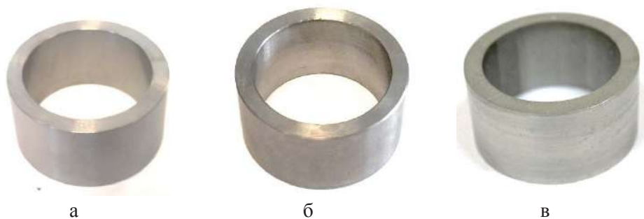
Рисунок 4 – Кольцевые катоды, где а – вольфрам, б – ниобий, в – иридий
