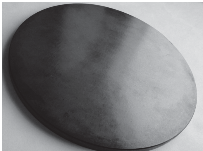
Рисунок 1 – Полированная пластина из реакционно–связанного карбида кремния для осаждения карбида кремния
